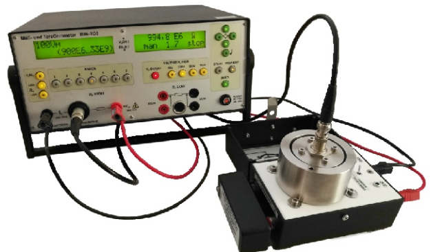
KB-FE50 mit FE 50*, Kalibrierwiderstand* und Milli-TO 3* (* optional)
