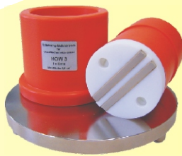
Handoberflächenelektrode HOW 3 mit GP 14
