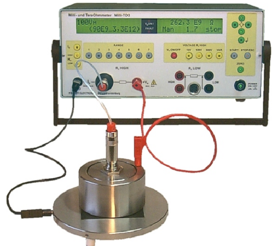
Messung Oberflächenwiderstand mit Grundplatte GP 14 und Milli-TO 3
