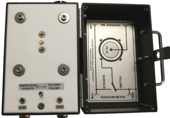
KB-FE50 mit FE 50 (optional) und Normalwiderstand (optional)
